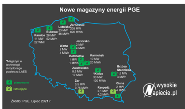
RYS.14. ROZMIESZCZENIE PLANOWANYCH AKUMULATOROWYCH MAGAZYNÓW ENERGII PGE S.A.
